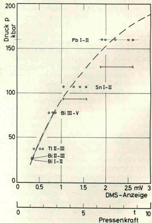
Abb. 3. Zusammenhang zwischen Zellen Druck und Pressenkraft. Die Meßpunkte stellen voneinander unabhängige Experimente dar. Die Verstimmung der DMS-Brücke ist der Kraft proportional;  $300\ \mu\text{V}$  entsprechen einer Kraft von etwa einer Tonne
